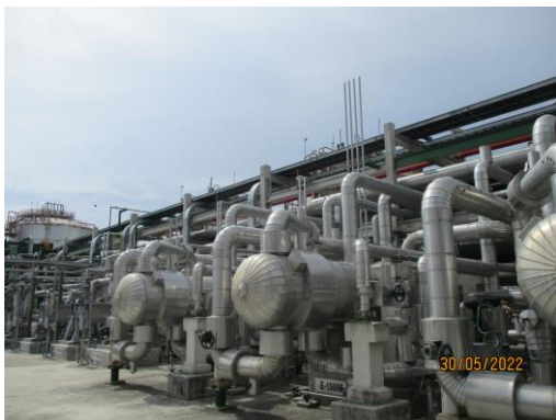
รูปที่ 3.56 ฉนวนหุ้มอุปกรณ์การผลิตเกี่ยวกับ โพพิลีนออกไซด์
